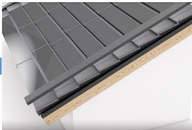
Kantenbearbeitung, Verlegung von Firstziegeln
